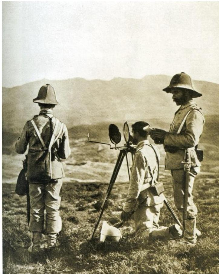
Fotografía 28. Estación de telegrafía óptica transmitiendo desde una de las alturas de Imarufen.
