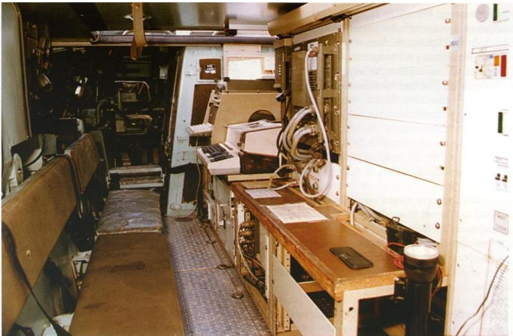
Fotografía 12. Central telefónica de RADITE instalada dentro de un BMR.
