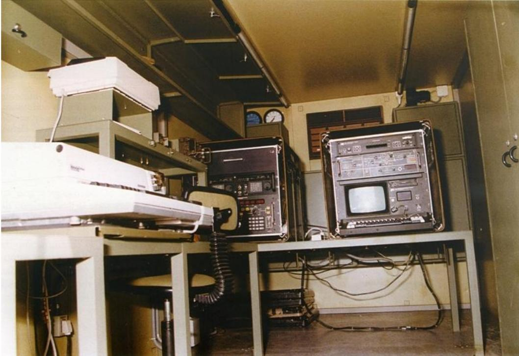
Fotografía 15. Sondador ionosférico.
