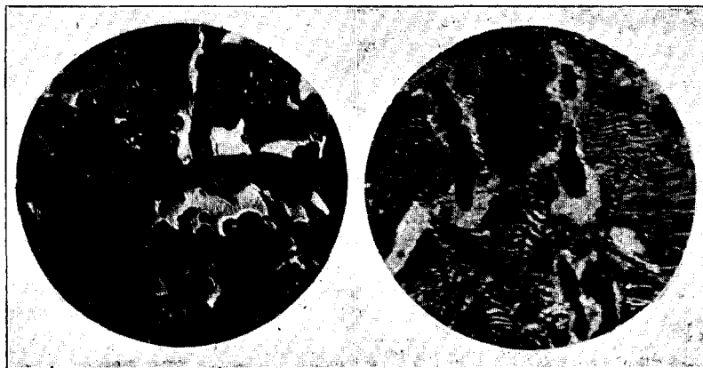
Fot. 11.—Grafito (negro), cementita y perlita. D = 150 . Acido pícrico.
