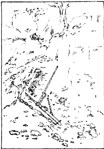
Fig. 5.—Trabajo de la perforadora en posición inclinada con punto de apoyo anclado.
