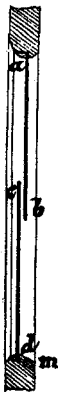
Fig. 24. Esta disposición da resultados excelentes para la ventilación de locales en los que se albergan gran número de personas, como son dormitorios de tropa, de colegios, etc.
